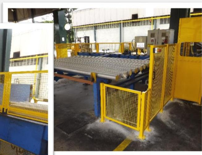
Análise de riscos, desenvolvimento de projeto, fabricação das proteções fixas e moveis, instalação mecânica e elétrica, laudos de conformidade. Adequação de acordo com a norma NR12.
