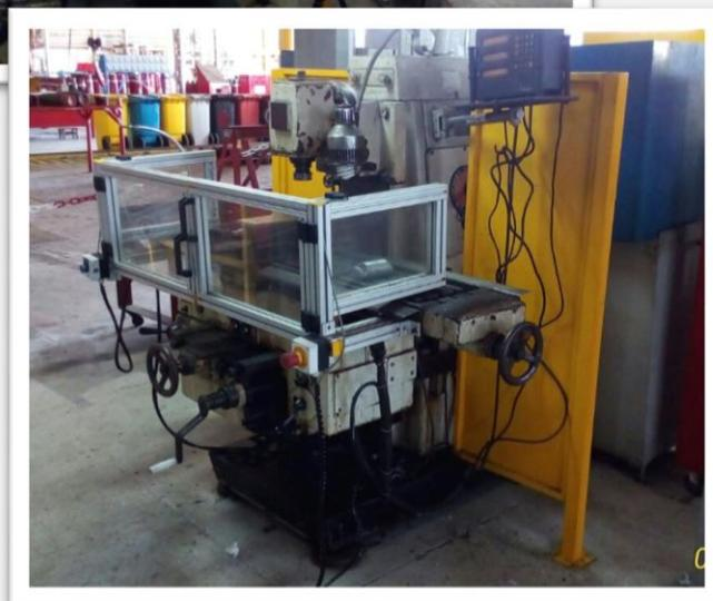
Análise de riscos, desenvolvimento de projeto, fabricação das proteções fixas e moveis, instalação mecânica e elétrica, laudos de conformidade. Adequação de acordo com a norma NR12.
