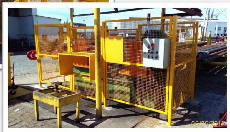
Análise de riscos, desenvolvimento de projeto, fabricação das proteções fixas e moveis, instalação mecânica e elétrica, laudos de conformidade. Adequação de acordo com a norma NR12.
